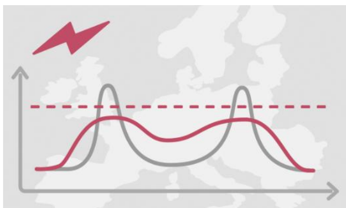
Figur 1. Grafisk illustration över morgonens och eftermiddagens förbrukningstoppar, avseende el [1]. Grå linje illustrerar förbrukning över dygnet utan batterilagring och röd linje illustrerar förbrukning med batterilagring.
